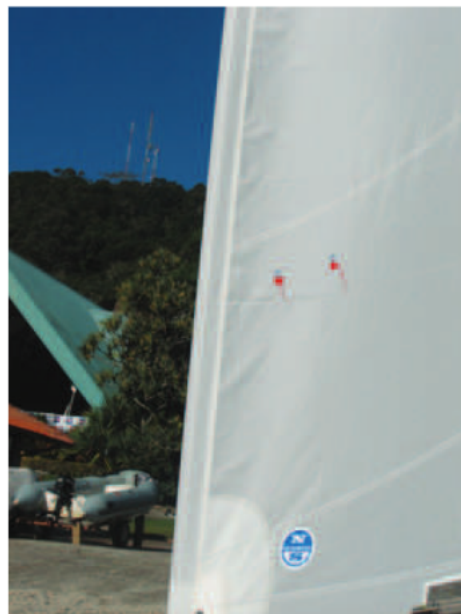
Tensão da testa em vento fraco
