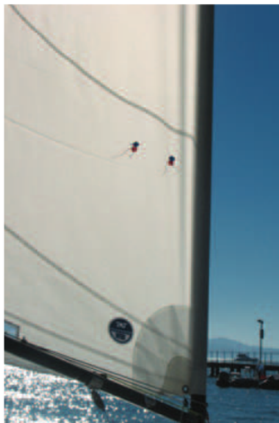
Tensão em excesso da testa
